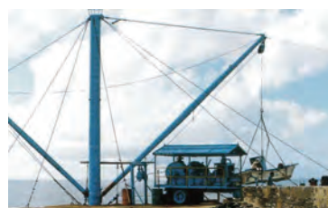
③ マストクレーン
