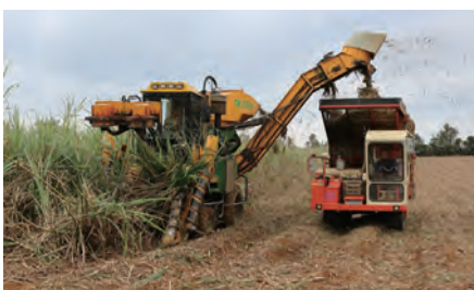
ハーベスターと搬出機による収穫
