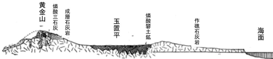
第二図 黄金山より玉置平を経て西海岸に至る断面
